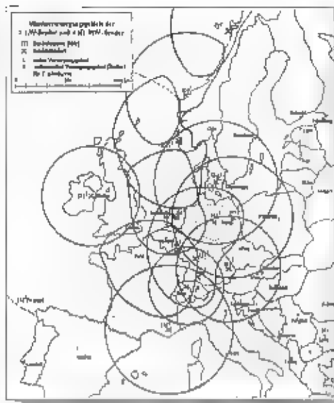
Amplitude Modulate Data System kan nauwkeurige navigatie in heel Europa brengen. Een weergave van het bereik van de zenders. 747 khz (Radio 1) dekt ook een groot deel van de Noordzee.
